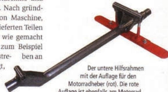
Der untere Hilfsrahmen mit der Auflage für den Motorradheber (rot). Die rote Auflage ist ebenfalls am Motorrad montiert. Darunter kann ein Wagenheber platziert werden.
